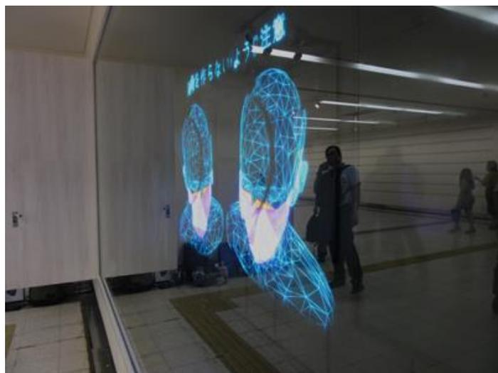
3D Phantom®とは、LED光源がライン状についたブレードを高速回転させ、光の残像によって映像を映し出すホログラムディスプレイです。VRやARの専用ヘッドセット(メガネ)は装着不要です。3D Phantom®で作られた3D映像は、浮いているような不思議な魅力で、人々の注目を集めることができます。
